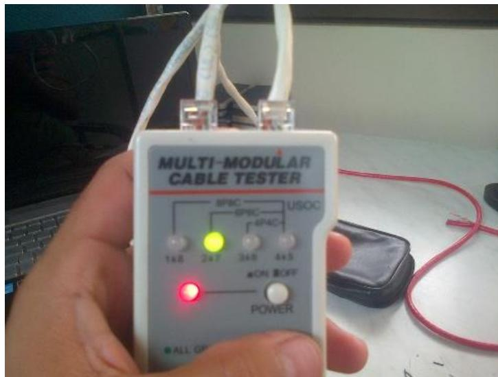
Para la revision de este cable utilzo el chequeador electrónico de cables. y ubico exactamente el cable en ambos lados del chequeador pues debo de tener encuenta que estan cruzados y verifco la continuidad.
