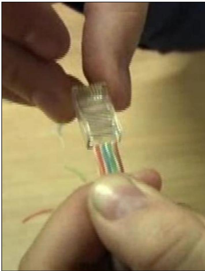
Verifico que los cables ingresen en el conector totalmente y procedo a asegurar con la ponchadora.
