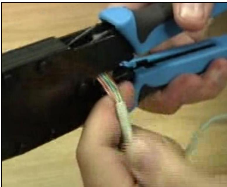
Ingreso los cables en el conector RJ45 con la lengüeta hacia abajo y el orden de los cables según la norma de izquierda a derecha.
